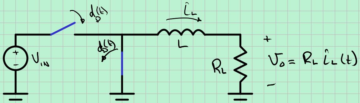
$$\text{For } d(t): \quad L \frac{di_L}{dt} = V_{in} - V_o = V_{in} - R_L i_L$$
